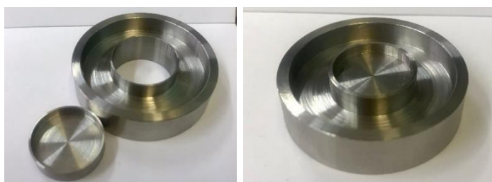
Рисунок 13 – Имитаторы корпуса в сборе
